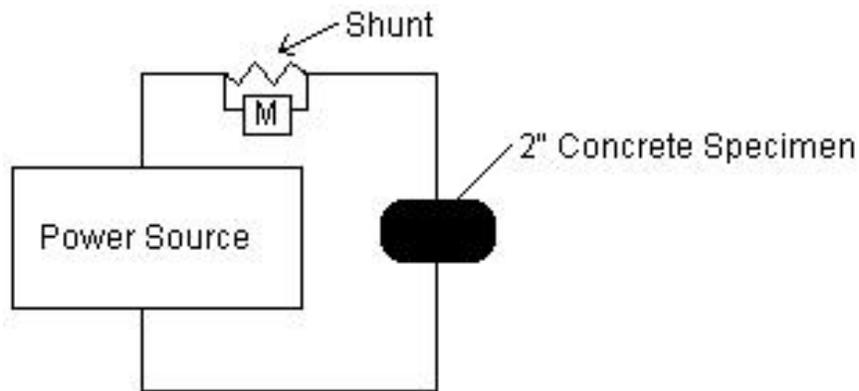
**Figure 32. AASHTO T277 testing apparatus**
